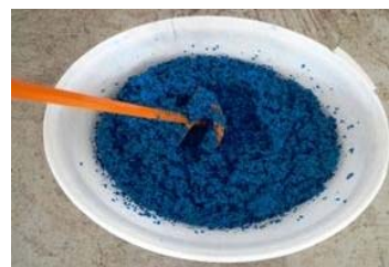
Gummi-Granulat und Bindemittel mit mechanisch angetriebenen Rührwerk gründlich vermischen
